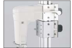
Stopper 반복측정시 센서 unit와 센서 plate의 높이(위치)를 고정시키기 위한 장치
